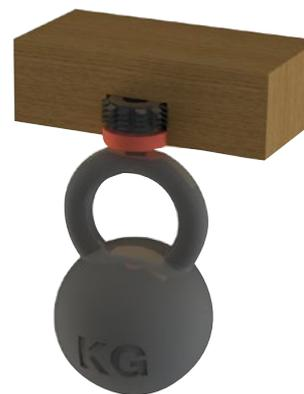
• **KEEP-NUT®** Il s'agit d'un insert fileté à enfoncer révolutionnaire avec ancrage mécanique pour créer un siège fileté sur des panneaux, même minces, fabriqués en marbre, granit ou autres matériaux en pierre, ainsi que sur des matériaux composites, du carbone, du Corian, du HPL, du verre et d'autres matériaux durs. Un trou simple suffit, montage rapide par pression. Pas besoin de résine
