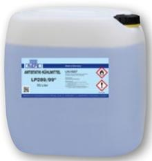
Insbesondere bei der Arbeit mit PUR-Schmelzklebstoffen ist das Riepe Anti-Statik Kühlmittel erforderlich, um eine Fuge nach dem Anleimen der Kante an die Platte schnell abzukühlen. Durch den Kühleffekt arbeiten die Folgewerkzeuge ungehindert weiter und setzen sich nicht mehr mit Klebstoff zu.
